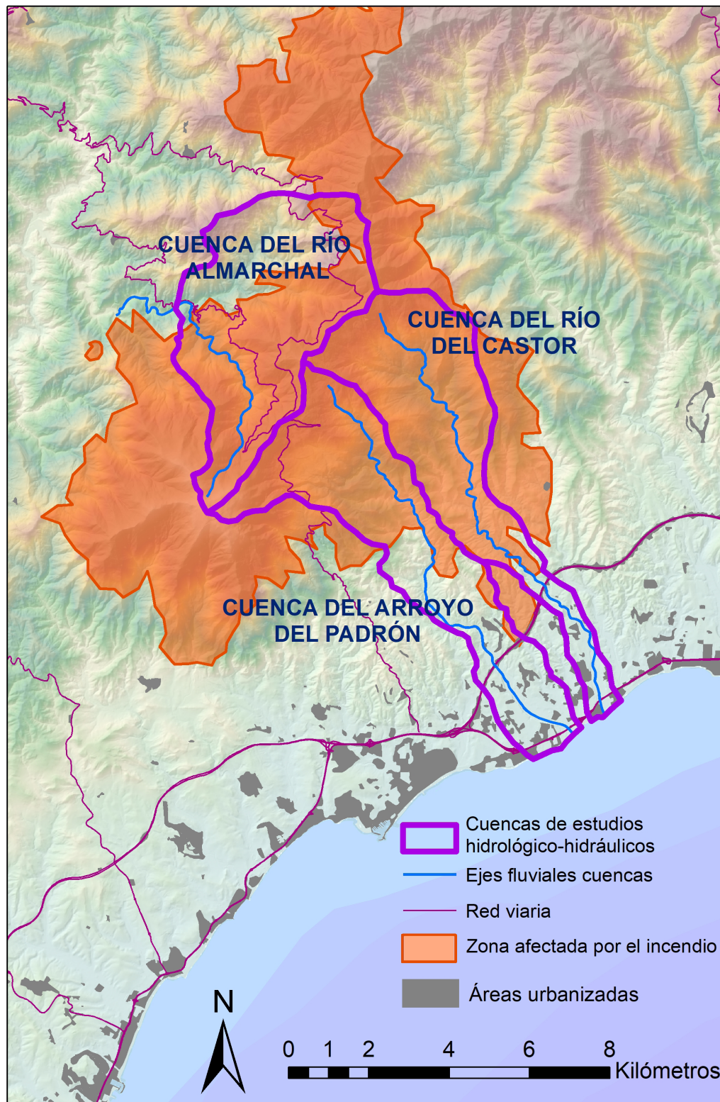
FIGURA 3. CUENCAS FLUVIALES ANALIZADAS MEDIANTE ESTUDIO HIDROLÓGICO-HIDRÁULICO
